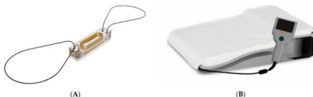
Рисунок 2. The CardioMEMS (микроэлектромеханическая система), состоящая из (А) сенсор для определения давления в легочной артерии; (В) система, принимающая сигналы от сенсора и направляющая данные в общую базу (Abbott, Sylmar, CA, USA).
